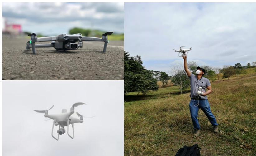
**Figura 3.** Aplicación de aeronaves tripuladas a distancias (Drones) para realizar ortofotografías aéreas y modelos digitales de elevaciones (MDE)
