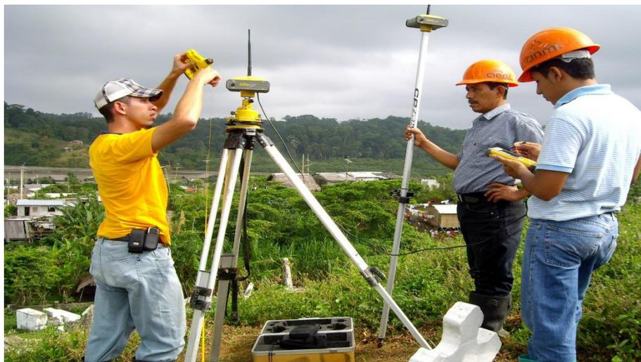
**Figura 2.** Equipo GPS con técnica GNSS diferencial RTK.
