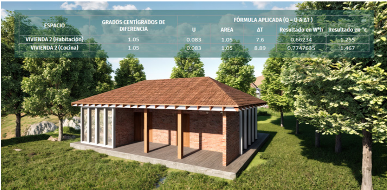
Figura 7. Simulación constructiva y resultados de aporte de grados centígrados
