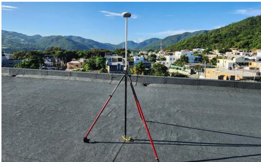
Figura 6. Receptor GNSS en Punto Base en techo de la Escuela Altagracia Brito
