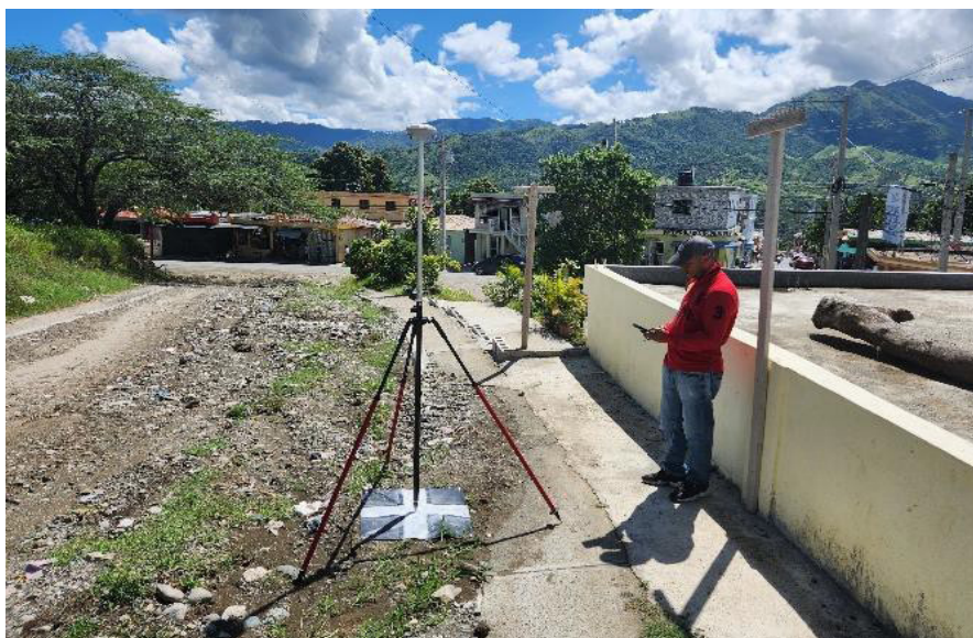
Figura 4. Se realiza el levantamiento NTRIP Punto de Control de Tierra GCP
