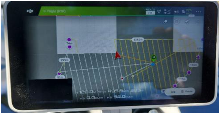
Figura 5. Pantalla del radio control del VANT durante ejecución plan de vuelo
